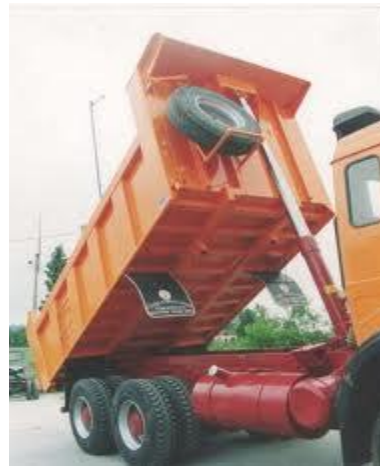
Ilustración 6. Sistema hidráulico de elevación
